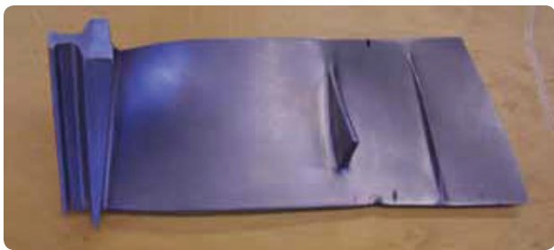
Figure 21-8. Fan blade damage.
